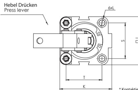
Wenn der Druckhebel und das V-Maß geändert werden, kann der Zylinder beschädigt werden und Luft austreten.
